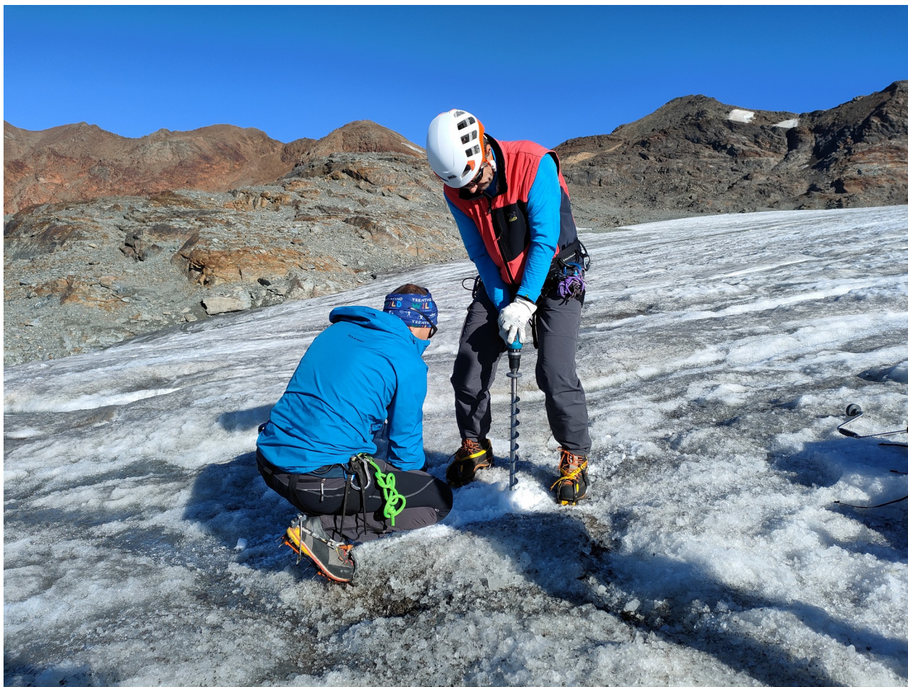
Figura 3 - Operazioni di trivellazione del ghiaccio mediante trivella meccanica Kovacs sul ghiacciaio del Careser, per l'inserimento di una palina di ablazione in alluminio costituita da 4 spezzoni da due metri di lunghezza ciascuno. Foto L. Carturan, 9 agosto 2022.
