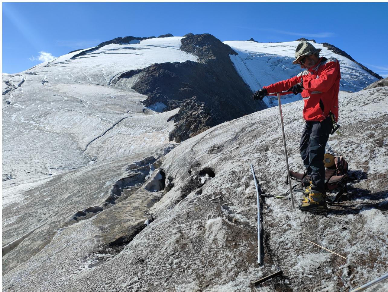
Figura 2 - Operazioni di trivellazione del ghiaccio mediante trivella manuale sul ghiacciaio de La Mare, per l'inserimento di una palina di ablazione in alluminio (a terra). Foto L. Carturan, 6 settembre 2022.
