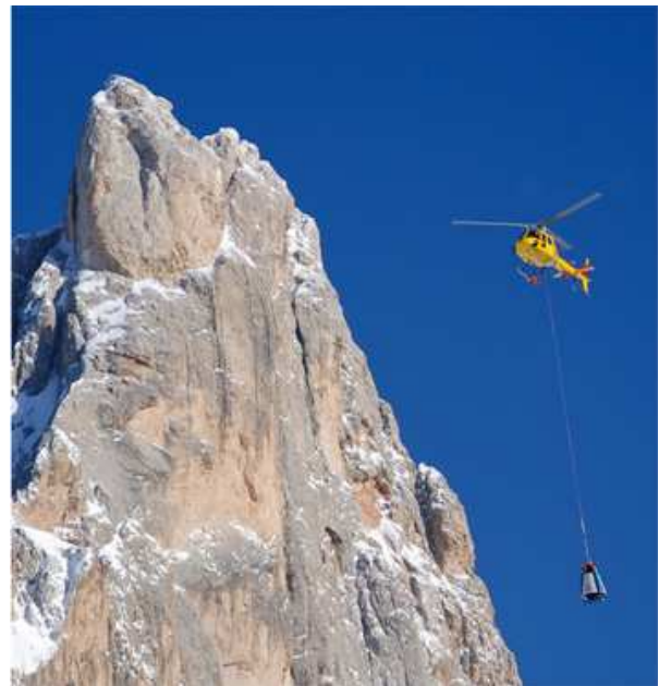
Figura 140: operazioni di distacco artificiale con dispositivo DaisyBell
