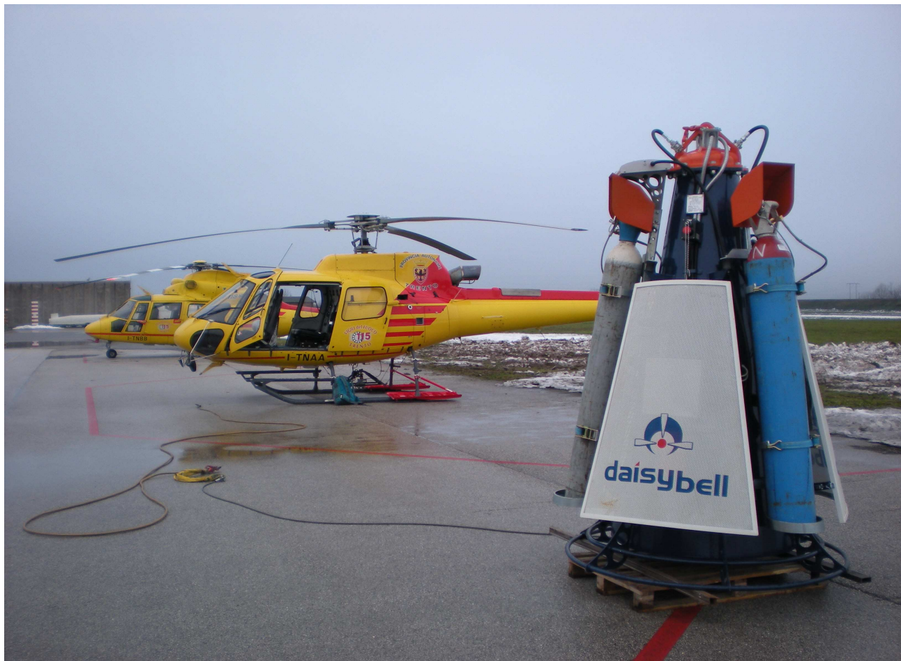
Figura 141: Il dispositivo per il distacco artificiale di valanghe denominato "DaisyBell" all'eliporto di Matterello (TN) durante la giornata di collaudo iniziale (16 dicembre 2008)
