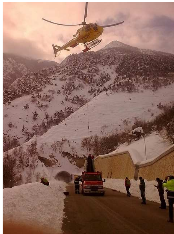
Figura 144: 14 febbraio 2012, Scanno (Abruzzo) –operazioni di distacco controllato di valanghe con dispositivo elitrasportabile "DaisyBell"
