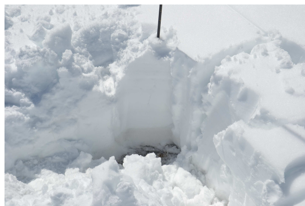
Figura 145: Stratigrafia del manto nevoso in isotermità (fradicio), eseguita il giorno dopo all'incidente del 25 aprile 2012
