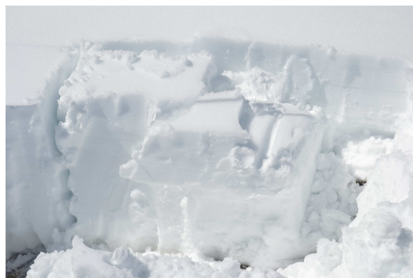
Figura 146: Test di stabilità “ECT” su manto nevoso in isoterma (fradicio), eseguito il giorno dopo all’incidente del 25 aprile 2012. Spessore del manto nevoso 70 cm circa
