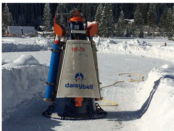
Figura 125: Dispositivo elitrasportabile per il distacco di valanghe “DaisyBell” della Provincia Autonoma di Trento
