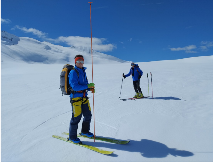
Figura 2 - Ghiacciaio del Mandrone, misure spessore manto nevoso su punti di coordinate note (foto SGL A.Lendvai)
