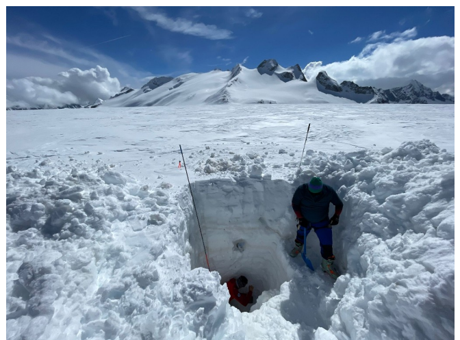
Figure 3-4 - A sinistra scavo di trincea per misure di densità manto nevoso. A destra scavo di profondità. (foto SGL A.Lendvai)
