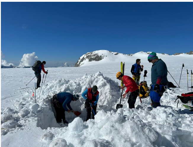
Figure 3-4 - A sinistra scavo di trincea per misure di densità manto nevoso. A destra scavo di profondità. (foto SGL A.Lendvai)
